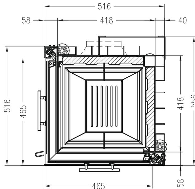
Einsatz für links und rechts einsetzbar – Auslieferung mit 2 Griffen
